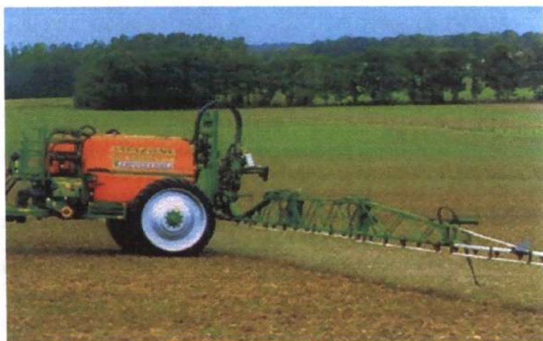
Рис. 26. Внесение почвенных гербицидов прицепным штанговым опрыскивателем – наиболее эффективный прием борьбы с сорняками
