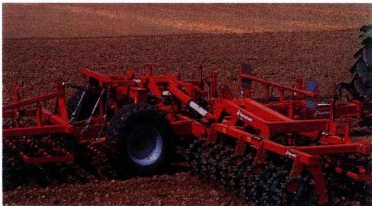
Рис. 19. Предпосевная культивация с выравниванием и уплотнением почвы кольчатыми катками под посев зерновых культур
