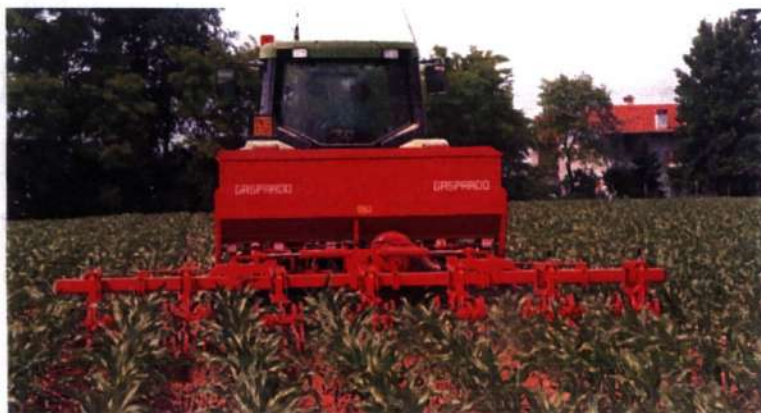
Рис. 20. Междурядная культивация с рыхлением, окучиванием и подкормкой азотными удобрениями посевов кукурузы
