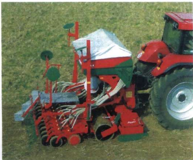
Рис. 24. Комбинированный почвообрабатывающее-посевной агрегат на севе промежуточной культуры в районах проявления дефляции
