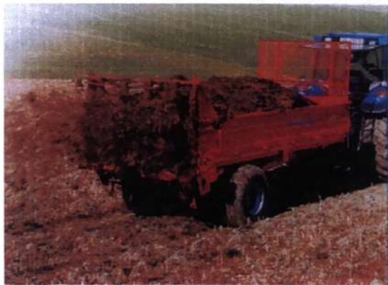
Рис. 12. Внесение органических удобрений разбрасывателями с вертикальными лопастями перед зяблевой обработкой почвы
