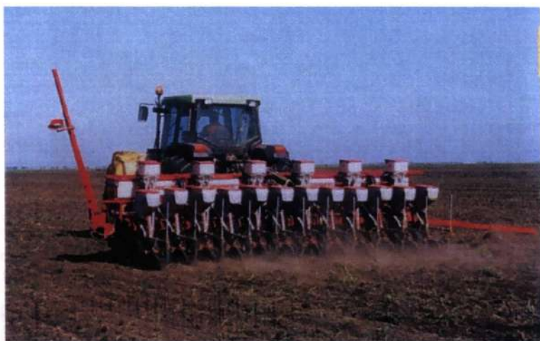
Рис. 23. Посев сахарной свеклы с междурядьями 45 см сеялкой точного высева с припосевным внесением комплексных удобрений
