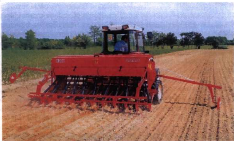
Рис. 22. Посев зерновых культур механической сеялкой с одновременным внесением минеральных удобрений
