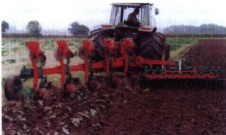
Рис. 15. Обратные плуги обеспечивают отвальную обработку без свальных и развальных борозд
