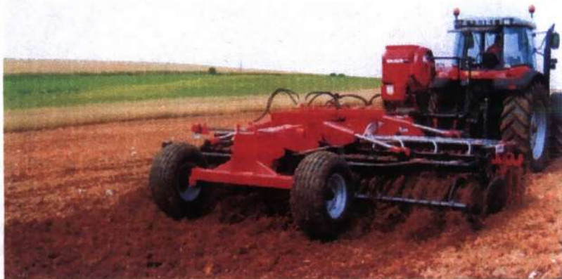
Рис. 16. Мелкая обработка тяжелой дисковой бороной обеспечивает высоко-качественную разделку почвы под посев озимых зерновых
