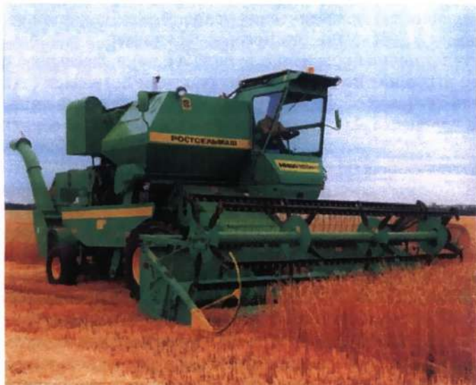
Рис. 25. Создание мульчирующего слоя на поверхности почвы из измельченной соломы при уборке озимой пшеницы
