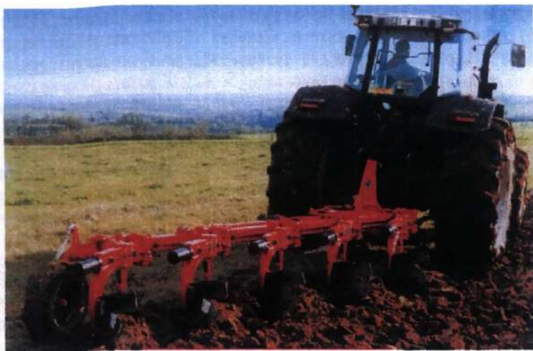
Рис. 14. Вспашка отвальными плугами с предплужниками обеспечивает полную заделку дернины многолетних трав и ускоряет ее разложение
